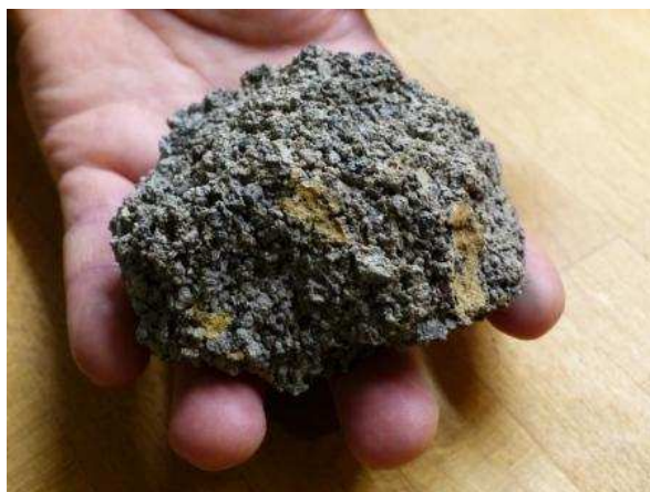
3. « Béton » d'époque, assez poreux
